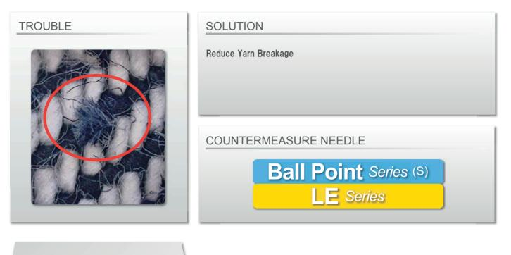
INCIDENCE OF FABRIC YARN BREAKAGE
